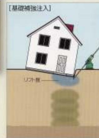
**2-i** 建物の基礎補強のため、基礎下部にグラウトを注入して「リフト盤」を形成させる。
