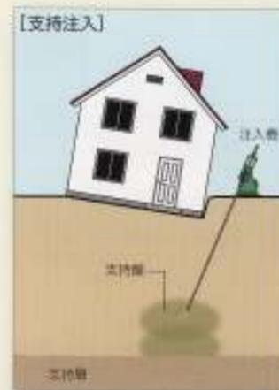
**1-i** 傾いたり沈下した建物を支えるため、支持層上にグラウト注入を繰り返し、「支持盤」を形成する。
