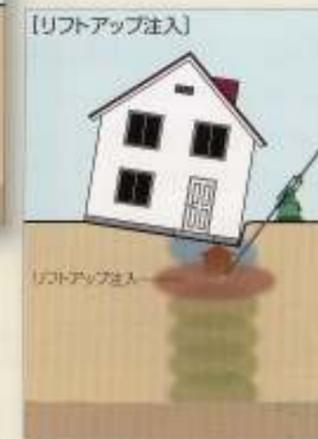
**3-i** 「支持盤」と「リフト盤」の間に「リフトアップ注入」を行い、「リフト盤」ごと建物を持ち上げる。
